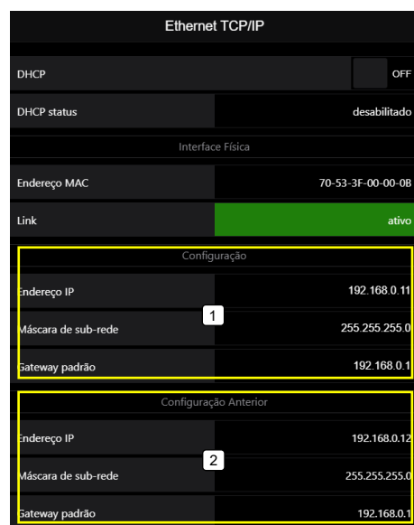
Figura 3 – Transmissor de Pesagem Automática 2712 em modo RESET IP (carrega as configurações de fábrica)
