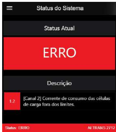
Figura 7 – Mensagem de erro da corrente de consumo do canal de pesagem fora da faixa
