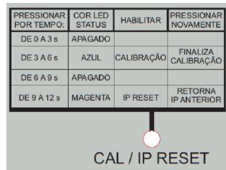
Figura 1 – Chave de CAL / IP RESET
