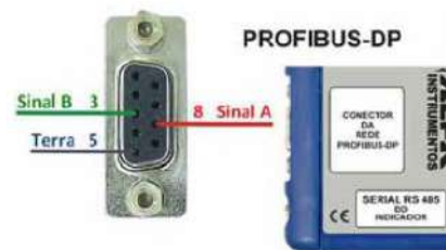
Figura 128 - Pinagem Conector PROFIBUS DP
