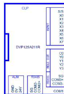
Figura 64 - Ligação Elétrica Modbus RTU COM3
