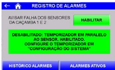
Figura 26 – Tela de Verificação de Alarmes
