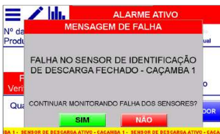
Figura 66 – Falha nos sensores das caçambas
