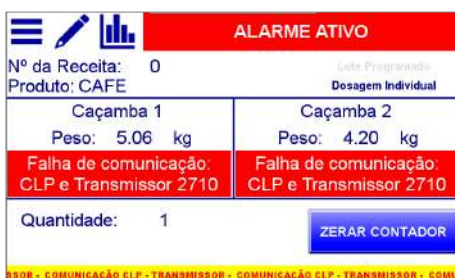
Figura 67 – Falha de comunicação entre o Transmissor 2710 e o controlador
