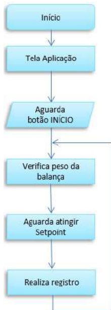
Figura 36 – Fluxograma de operação Balança de Fluxo
