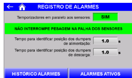
Figura 51 – Interromper dosagem na falha dos sensores desativado Dosadora a Granel
