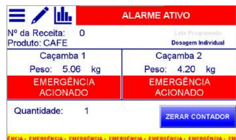
Figura 70 – Botão de emergência acionado
