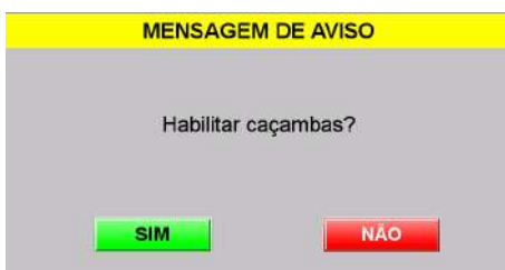
Figura 31 – Janela de confirmação para habilitar caçambas
