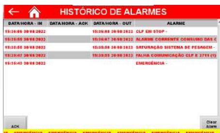
Figura 49 – Histórico de alarmes ocorridos Dosadora a Granel
