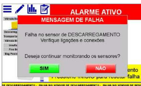
Figura 56 – Pop-up falha no sensor de Descarregamento
