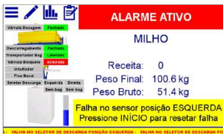
Figura 148 – Tela inicial com falha na posição esquerda Falha no sensor de identificação da posição DIREITA:
