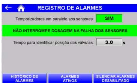
Figura 25 – Interromper dosagem na falha dos sensores desativado
