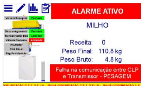
Figura 48 – Mensagem de falha de comunicação entre o CLP e Transmissor de Pesagem 2711
