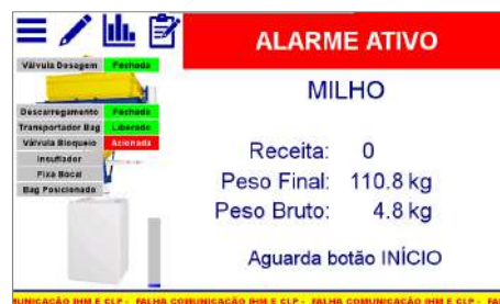
Figura 53 – Mensagem de comunicação entre IHM e CLP
