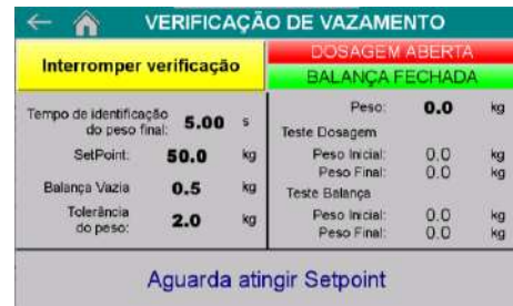
Figura 4 – Tela Verificação de Vazamento em operação
