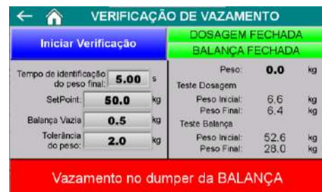
Figura 7 – Mensagem de vazamento na balança
