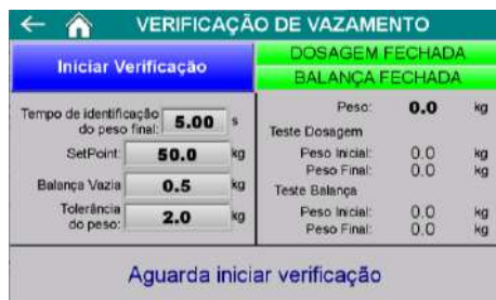
Figura 2 – Tela Verificação de Vazamento
