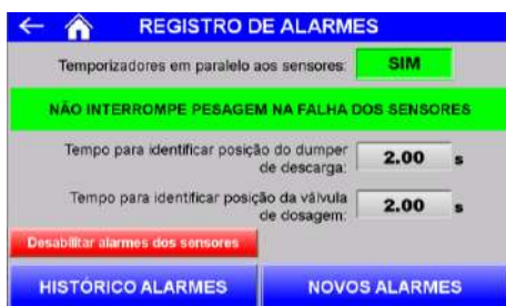
Figura 16 – Tela Registro de Alarmes (temporizadores habilitados)
