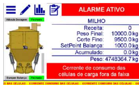
Figura 45 – Mensagem de falha de corrente de consumo das células de carga fora da faixa configurada
