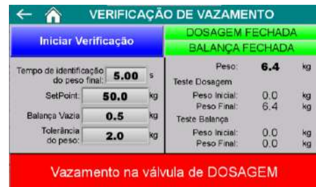
Figura 6 – Mensagem de vazamento na válvula de dosagem
