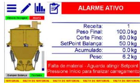
Figura 14 – Alarme de falta de material ativo
