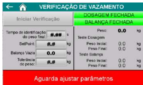
Figura 3 – Tela Verificação de Vazamento erro dos parâmetros
