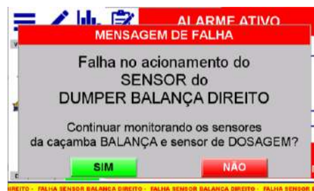
Figura 50 – Pop-up falha no sensor balança direito
