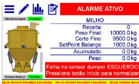
Figura 53 – Solicitação do botão início para resetar falha sensor de dosagem
