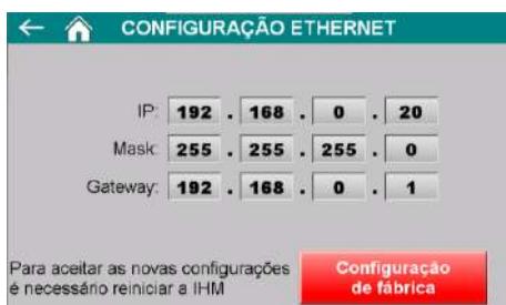
Figura 54 – Tela de configuração dos parâmetros da porta Ethernet TCP/IP
