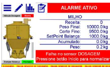
Figura 49 – Solicitação do botão início para resetar falha sensor de dosagem
