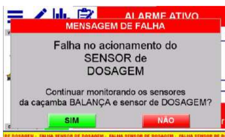
Figura 48 – Pop-up falha no sensor de Dosagem
