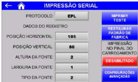
Figura 22 – Configuração dos parâmetros de impressão serial EPL
