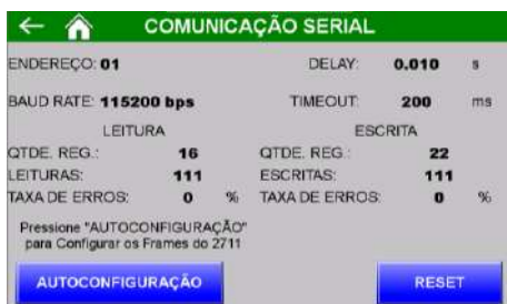
Figura 125 – Tela de autoconfiguração dos parâmetros de comunicação
