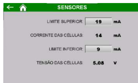
Figura 46 – Tela de configuração da faixa de trabalho da corrente de consumo das células de carga conectadas
