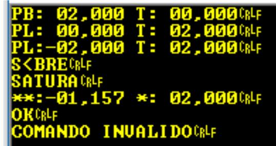
Figura 26 – Captura dos dados via terminal ASCII (protocolo AA)
