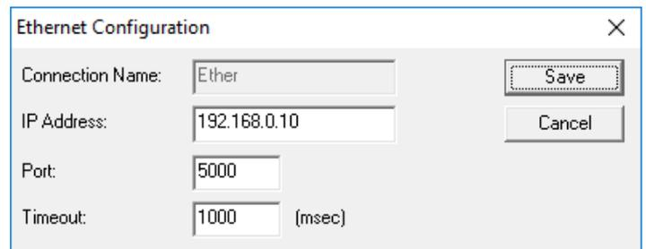
Figura 17 – Configuração no software DAQFactory. Deve-se colocar o IP e porta locais configuradas no indicador
