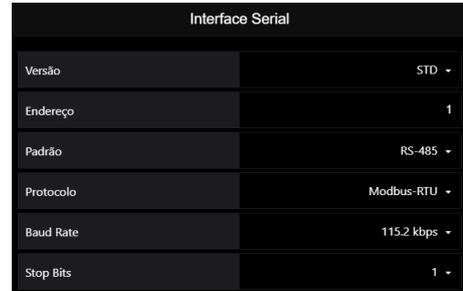
Figura 55 – Configuração da Interface Serial via Alfa Web Monitor
