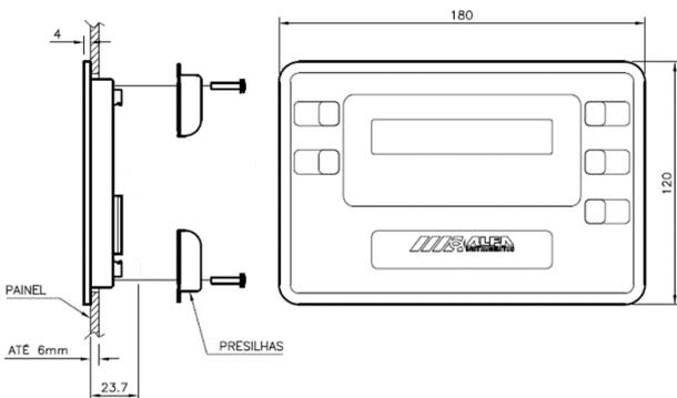
Figura 8 – Linha 3100DS dimensões do Indicador de Pesagem
