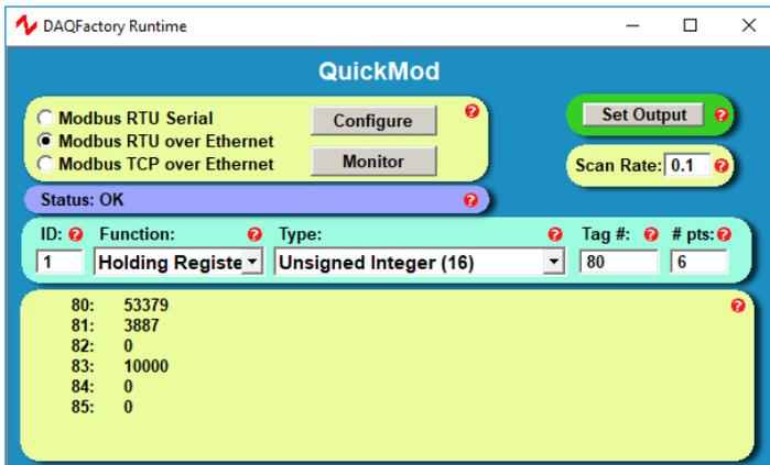
Figura 18 – Leitura de peso e status do indicador via Modbus-RTU over Ethernet
