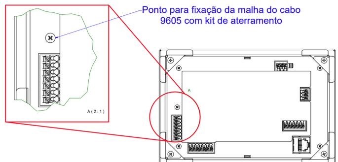
Figura 3 – Linha 3100DS detalhe local fixação terra
