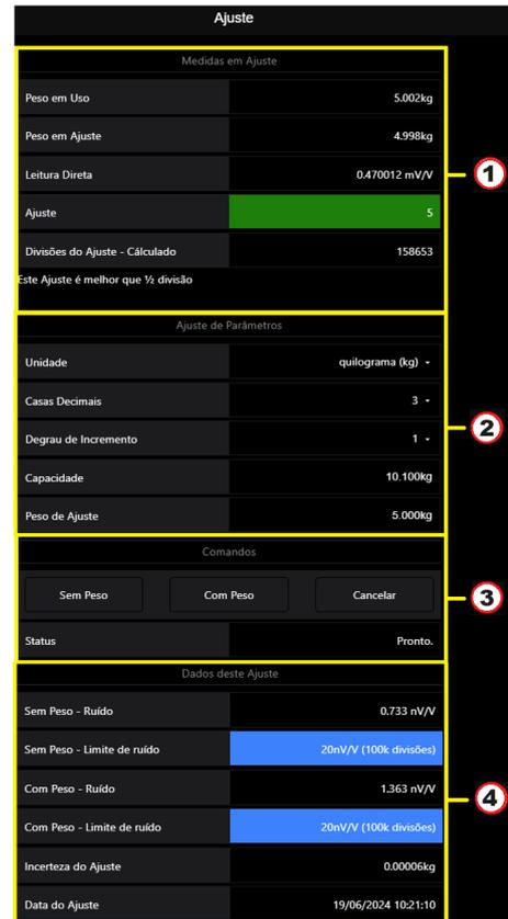
Figura 60 – Página de configuração de Ajuste via Alfa Web Monitor
