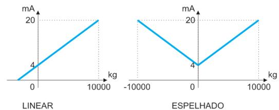
Figura 36 – Comportamento da Saída Analógica (LINEAR e ESPELHADO)
