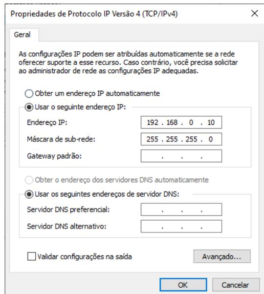
Figura 41 – Configuração de IP da porta de rede conectada ao Indicador de Pesagem
