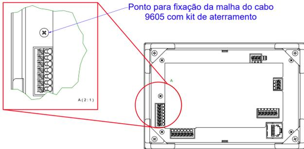
Figura 14: Detalhe da instalação da blindagem do cabo de Célula de Carga 3100DS
