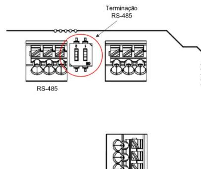
Figura 27 – Chaves de acionamento do terminador (no destaque). Indicador Linha 3100D, necessário abrir a caixa para ter acesso.
