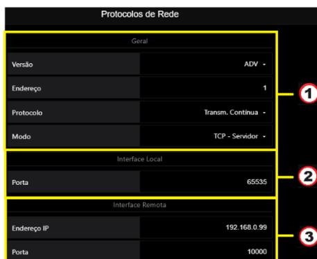
Figura 54 – Página de configuração de Protocolos de Rede via Alfa Web Monitor
