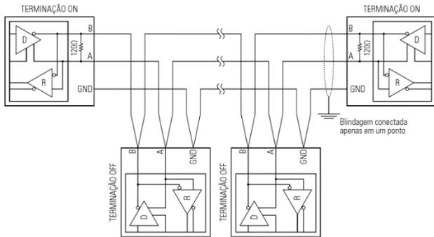
Figura 28: Exemplo de esquema para linha de comunicação RS485 com utilização correta de terminadores
