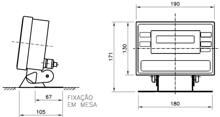
Figura 6 – Linha 3100D detalhe fixação em Mesa e dimensões
