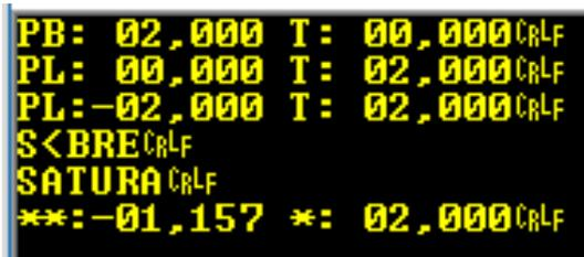
Figura 25 – Captura dos dados via terminal ASCII (protocolo TRC)
