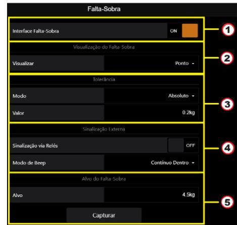
Figura 51 – Página de configuração Falta-Sobra via Alfa Web Monitor
