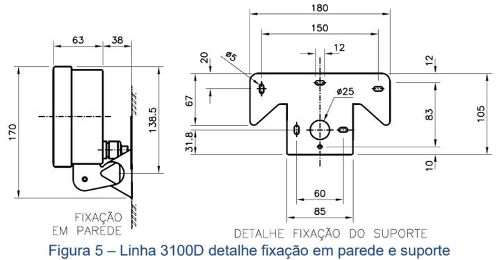
Figura 5 – Linha 3100D detalhe fixação em parede e suporte
