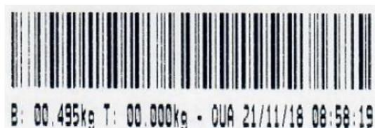
Figura 31 – Protocolo EPL, impressão Peso e Tara (dimensões aproximadas 65x25mm)
