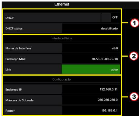
Figura 53 – Página de configuração Ethernet via Alfa Web Monitor
