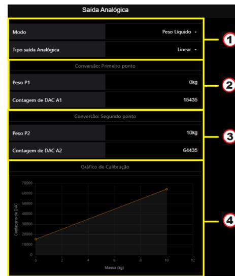
Figura 57 – Página de configuração de Saída Analógica via Alfa Web Monitor
