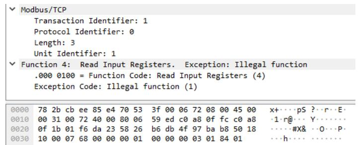
Figura 20 – Software Wireshark, mensagem função inexistente
