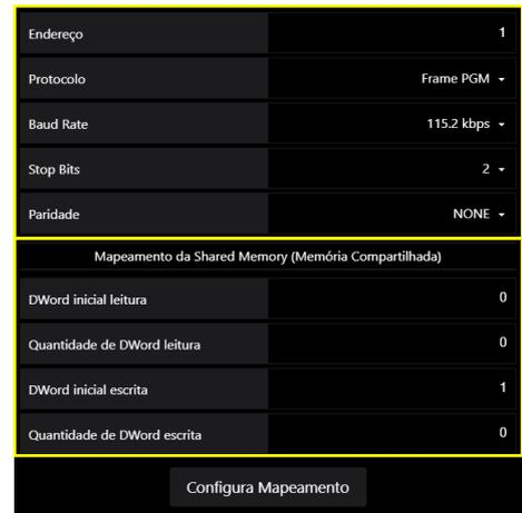
Figura 126 – Tela de configuração dos parâmetros do Modbus RTU
