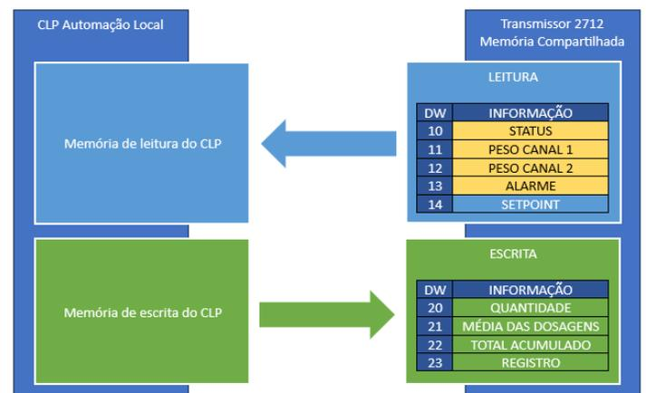
Figura 142 – Exemplo da troca de dados do CLP configurado com PGM e acesso a Memória Compartilhada
