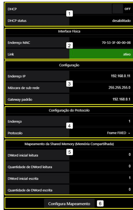
Figura 113 – Tela de configuração dos parâmetros Ethernet TCP/IP
