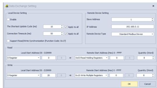
Figura 120 – Configurações da comunicação *Modbus TCP*
