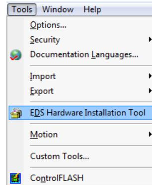
Figura 56 – Instalação arquivo EDS
