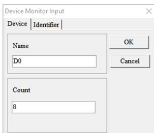
Figura 124 – Adição das words de leitura ao monitor (Modbus TCP)
