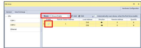
Figura 134 – Habilitação da comunicação Modbus RTU
