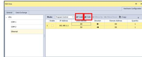
Figura 119 – Criação de nova comunicação *Modbus TCP*
