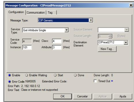
Figura 75 – Configuração Read Message para RSLogix 5000
