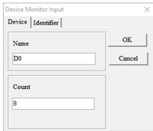
Figura 137 – Adição das words de leitura ao monitor (Modbus RTU)
