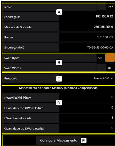
Figura 54 – Tela de configuração dos parâmetros EtherNet/IP™
