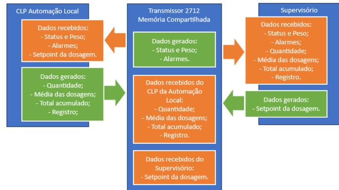
Figura 140 – Exemplo da troca de dados entre as portas de comunicação utilizando a Memória Compartilhada do Transmissor 2712
