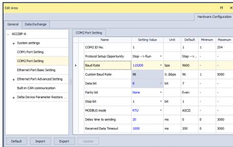
Figura 130 – Configurações Modbus RTU do controlador
