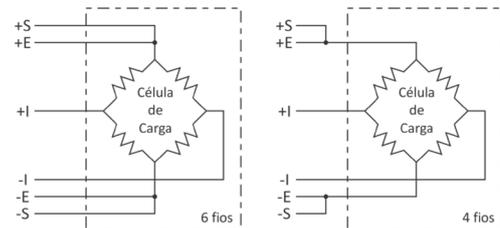
O Transmissor 2712 também está preparado para aplicações que necessitem de uma quantidade maior de células de carga, como em plataformas múltiplas e balanças siderúrgicas. A capacidade de excitação de até 32 células de carga de 350Ω ou ainda 64 células de carga de 700Ω.
