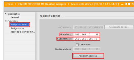
Figura 88 – Configuração dos parâmetros IP
