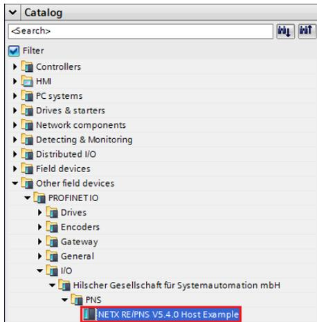
Figura 92 – Arquivo GSDML instalado no Catalog
