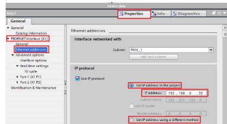
Figura 97 – Propriedades do Transmissor → configuração IP
