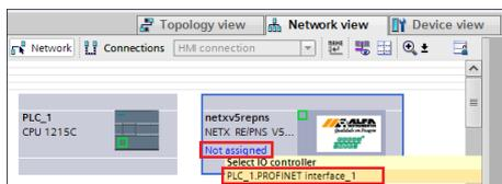
Figura 94 – Conexão do Transmissor na rede
