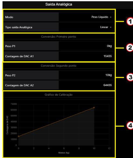
Figura 63 – Página de configuração de Saída Analógica via Alfa Web Monitor
