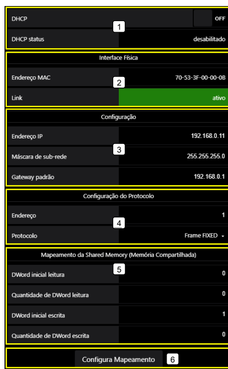
Figura 126 – Tela de configuração dos parâmetros Ethernet TCP/IP
