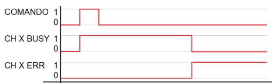
Figura 165 – Comportamento dos bits “CH X BUSY” e “CH X ERR”
