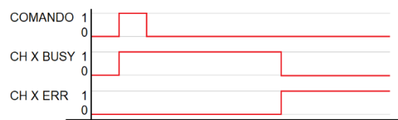
Figura 167 – Comportamento dos bits “CH X BUSY” e “CH X ERR”
